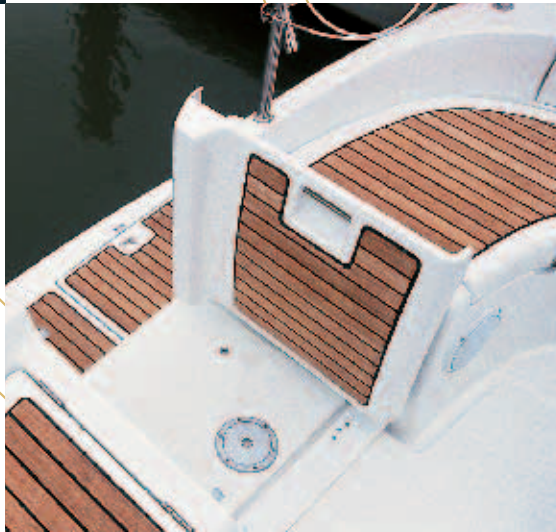
Banc barreur pivotant (brevet Bénéteau).
